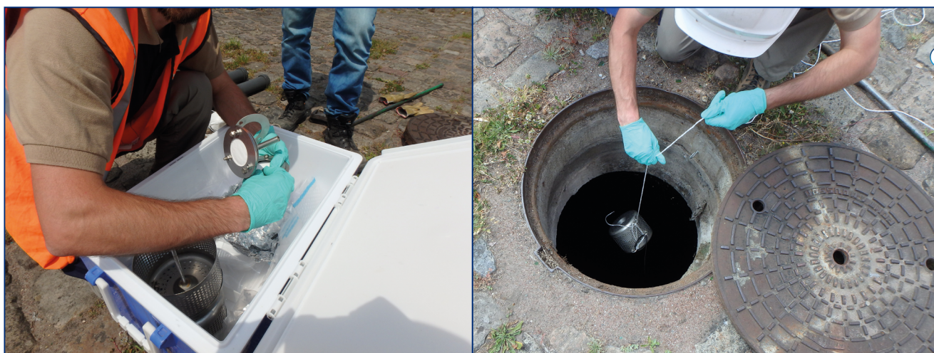
Figure 7 : Illustration du montage et du déploiement en réseau d'assainissement d'échantillonneurs intégratifs de type POCIS (Source : M.J. Capdeville, Suez – Regard)
